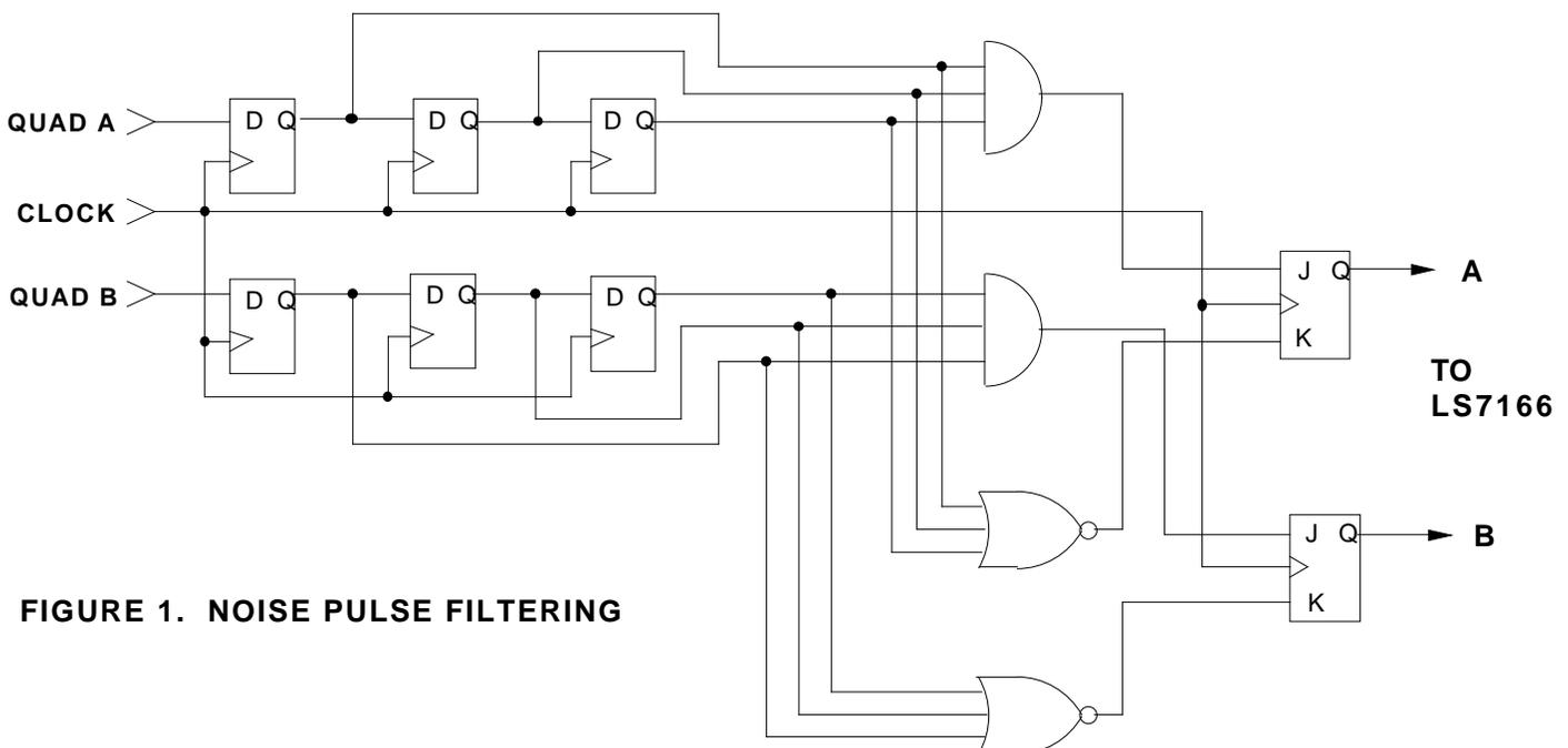
FIGURE 1. NOISE PULSE FILTERING
